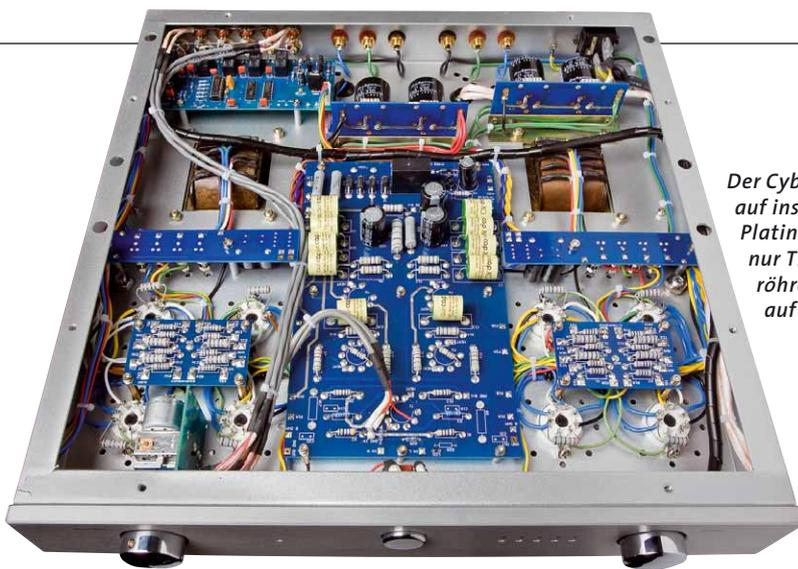
*Der Cyber 880i ist auf insgesamt neun Platinen aufgebaut, nur Trafos und Endröhren sitzen direkt auf dem Chassis*
